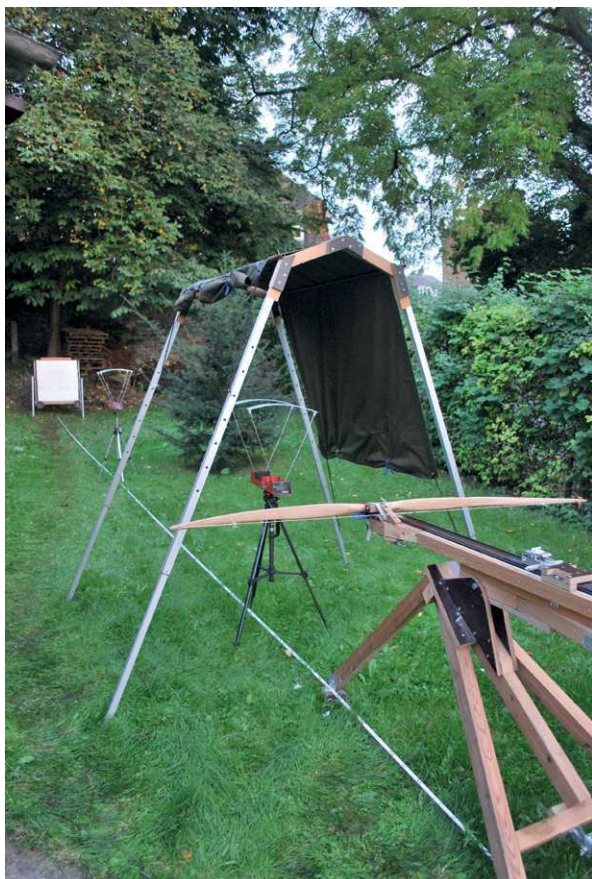
FIG. 7 – L'ensemble du dispositif de tir lors de la première expérimentation : l'arbrier avec l'arc, les deux chronographes à 1 m et 6 m de l'arc et, au fond, la cible destinée à recueillir les projectiles.
