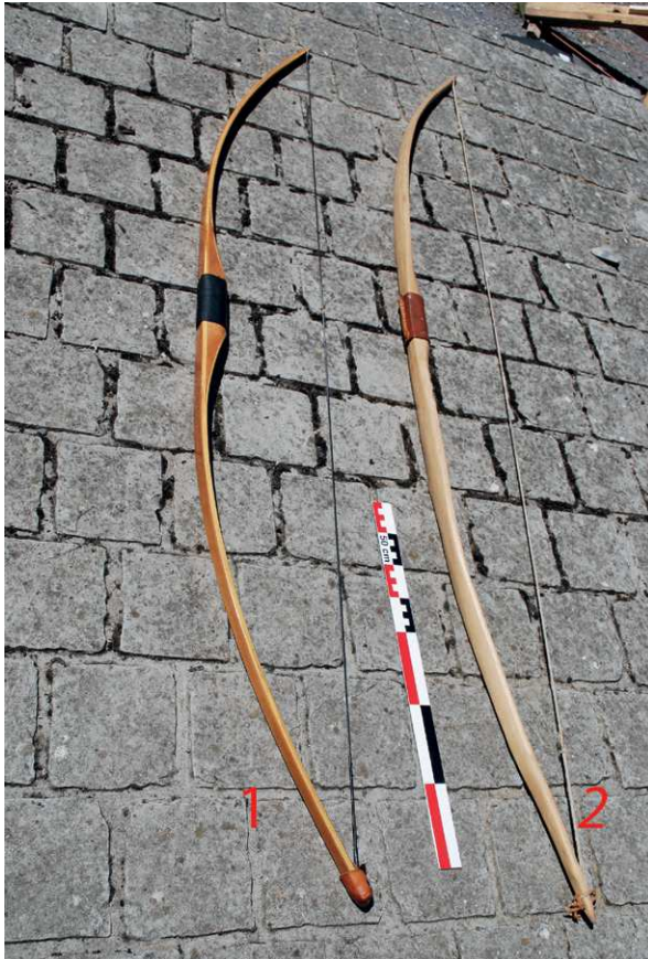
FIG. 1 – Deux des arcs utilisés pour les expérimentations. À gauche, l'arc « Merlin » (1) ; à droite, l'arc en orme « flatbow 1001 » (2), réalisé par l'auteur.
