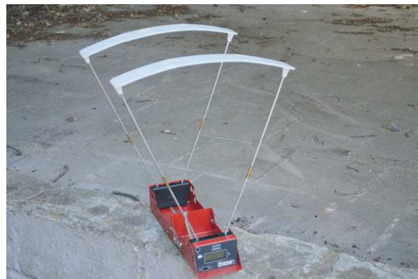
FIG. 6 – Le type de chronographe utilisé pour les expérimentations.
