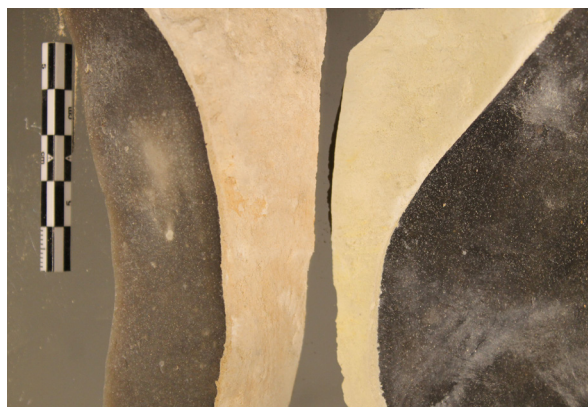
FIG. 7 – Changement de coloration du cortex après une chauffe à 300 °C dans un bain de sable. À droite, l'éclat témoin non chauffé ; à gauche, l'éclat chauffé (cliché M. Michel, 2017).
