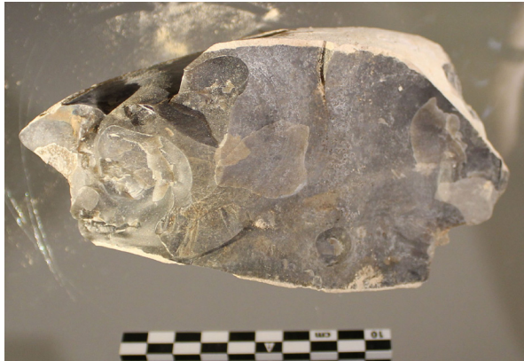
FIG. 8 – Fissuration du bloc 1 après une chauffe à 300 °C dans un bain de sable (cliché m. Michel, 2017).
