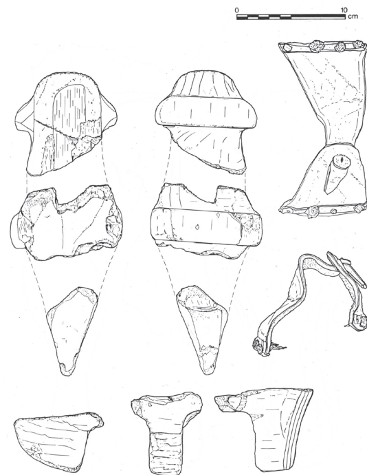
Fig. 5 – Dessin de la bride du patin découvert sur le site de la rue Taison à Metz. La lanière de cuir est encore en place à la base des brides. La vue de profil montre bien le système d'imbrication entre les brides intérieure et extérieure. La vue du dessus indique de quelle manière le petit clou est fiché dans les deux brides afin de les maintenir en place (© CETBGE).
