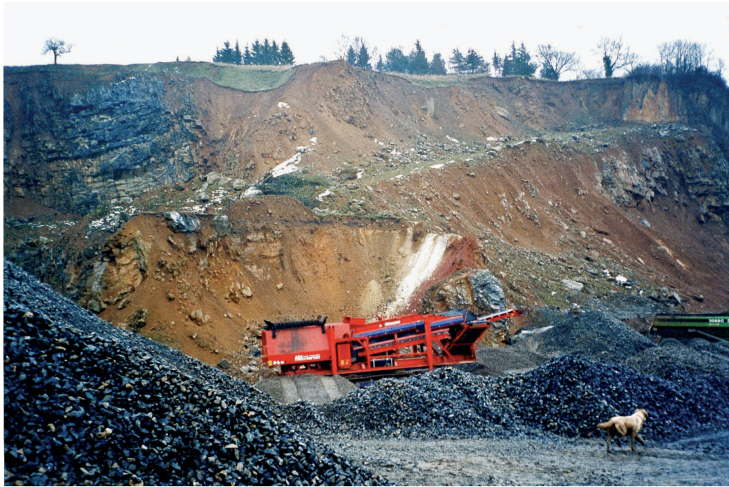
FIG. 15. – Front de la carrière de Dolhain au droit de Honthem. Les pseudo-dolines laissées par les minières sont recoupées par les travaux (lieu-dit « Les Fosses », point ⑦ sur la figure 1). Au-dessus de la machine, sables rouges et blancs et déchets de boisages.
