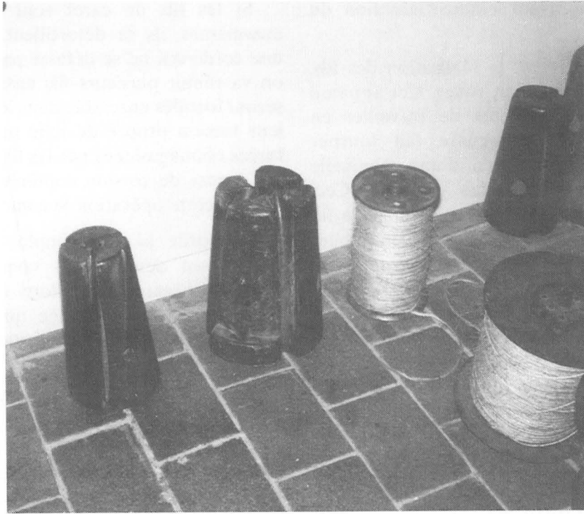
FIG. 6. – Différents modèles de toupins. Toupins pour aussières à trois torons à gauche, pour aussières à quatre torons à droite. À l'extrême droite, deux rouleaux de fil de caret.
